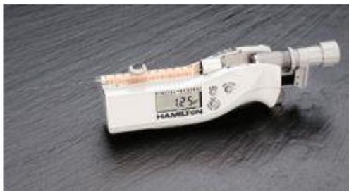
Электронный ручной дозатор, использующий шприцы 700, 1700 или 7000 серий, что обеспечивает диапазон номинальных объемов от 0.5 до 500 мкл. Имеет жидкокристаллический дисплей с разрешением 0.5% от номинального объема шприца. Номинальный объем, используемая серия шприца и дозируемый объем программируются пользователем.
