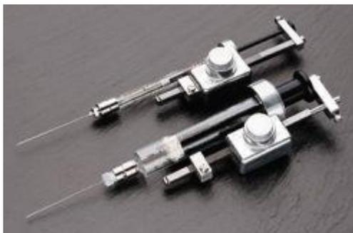
Предназначен для повторяющегося дозирования одинаковых микрообъемов. За один шаг дозируется 1/50 объема шприца, что обеспечивает дозирование от 0.5 до 200 мкл на шаг. Позволяет работать с одноразовыми наконечниками различных производителей. Использует шприцы серий 700, 1700 и 1000 объемом 25 мкл - 10 мл. Выпускается в двух модификациях - РВ 600-1 (на объем шприца 25 мкл - 2.5 мл) и РВ 600-10 (на объем шприца 5 и 10 мл).
