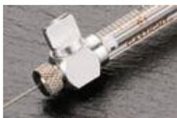
Это шприц серии 1000 или 1700, который содержит встроенный поворотный клапан, позволяющий фиксировать образец в шприце.
