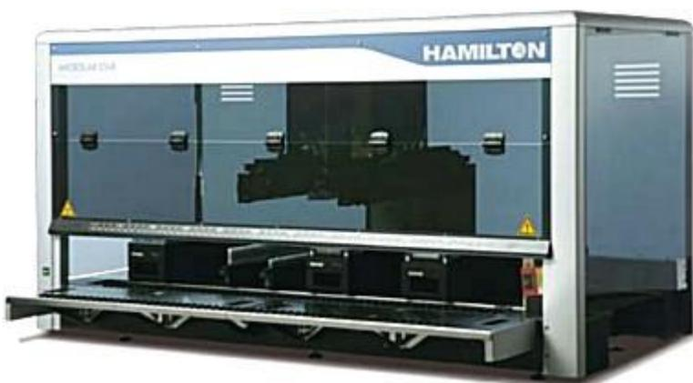
Автоматическая дозирующая система (робот-дозатор) **Microlab STAR** предназначена для автоматизации различных процессов дозирования жидкостей: внесения компонентов реакционной смеси в соответствующие емкости, аликвотирования разнообразных жидкостей в требуемые носители (планшеты, пробирки различных форматов и т.д.), выделения продуктов реакции и многих других.
