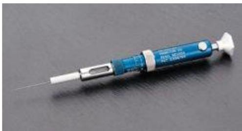
Объем дозирования предустанавливается микрометрическим винтом и фиксируется. Воспроизводимая скорость инъекции получается за счет использования пружин. Дозирование осуществляется нажатием на кнопку.
