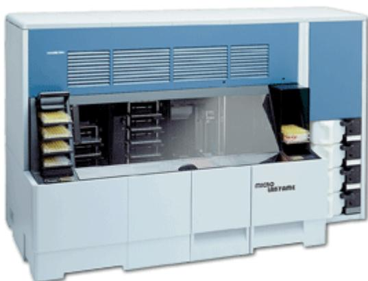
Автоматизированный комплекс **Microlab FAME/ATplus2** предназначен для автоматизации процесса иммуноферментного анализа в микропланшетном формате при исследовании на ВИЧ, гепатиты, сифилис и другие инфекции, а также количественного определения различных веществ (например, гормонов) при массовом обследовании населения (скрининге), **необходимость внедрения** которой давно назрела в нашей стране. Областью применения комплекса являются:
