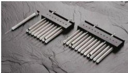
Для дозирования одинаковых микрообъемов образцов ДНК в диапазоне 0.2 - 10 мкл по 2 - 12-ти каналам одновременно на гелевые диски или напрямую в гель. Для упрощения работы предусмотрены регулируемые ограничители хода поршня.
