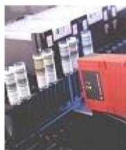
Опция автозагрузки позволяет не только автоматизировать процесс загрузки и выгрузки штативов на/с рабочего стола по командам программы без прерывания работы, но и обеспечивает штрих-кодovou идентификацию всех загружаемых носителей (с вертикальным или горизонтальным форматом наклеек), а также контролирует их соответствие требуемым в программе.
