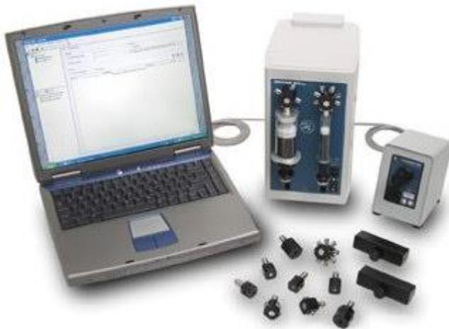
Автоматический дилютер ML560 Liquid Handler обладает всеми возможностями ML500 и, кроме этого, позволяет выполнять целый ряд дополнительных задач. Новый пакет программного обеспечения, который также может контролировать все M500B/C насосы, дополнен различными клапанами более 10 уникальных конфигураций.
